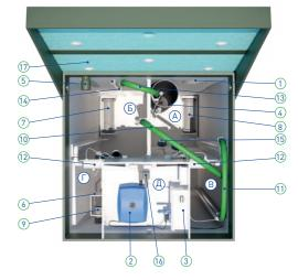
УОСВ осуществляют очистку, а не аккумуляцию стойника и вновь попадает в аэрируемое пространство (накапливание) стоков. Работа УОСВ основана на принципе SBR-реактора: в одном активном объеме сооружения (приемной камере и аэротенке) сочетаются аэробная и анаэробная очистка при использовании системы прерывистой (импульсной) мепкопузырчатой аэрации. Дополнительно в фазе выключения аэрации происходит процесс отстаивания загрязнений.
