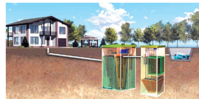
ОТВЕДЕНИЕ ЧЕРЕЗ БИОРЕАКТОР ДООЧИСТКИ
