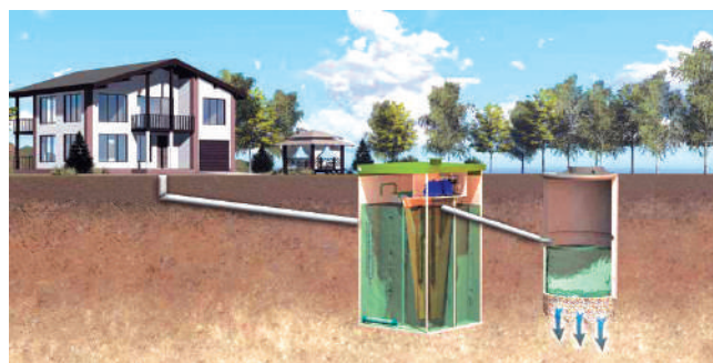
ОТВЕДЕНИЕ В ДРЕНАЖНЫЙ КОЛОДЕЦ
