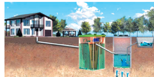
ОТВЕДЕНИЕ В ДРЕНАЖНУЮ КАНАВУ ЧЕРЕЗ НАКОПИТЕЛЬНЫЙ КОЛОДЕЦ
