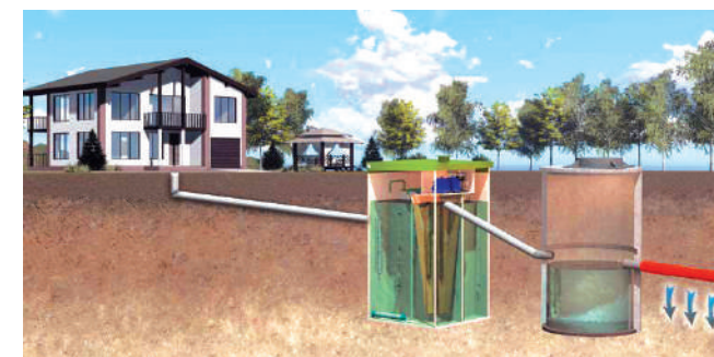
ОТВЕДЕНИЕ В ПОЛЯ ФИЛЬТРАЦИИ
